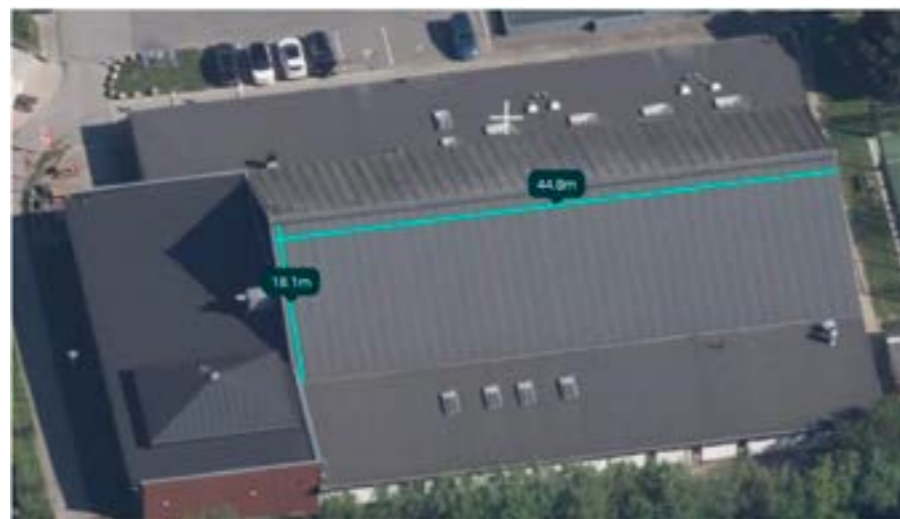
Hallens tagareal mod syd er ca. 18 x 45 meter - så der er plads til nogle solceller...
